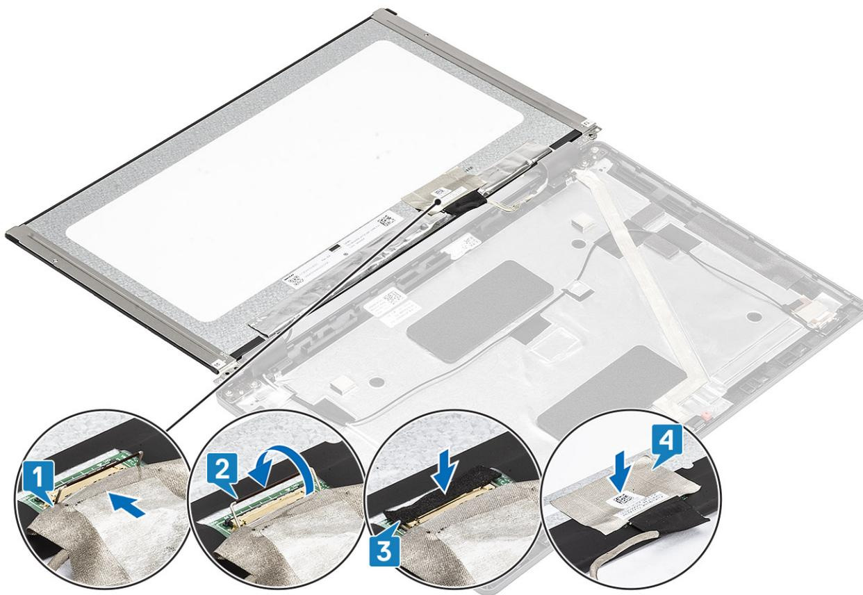
3. 粘上导电胶带以固定显示屏线缆连接器。LCD 面板配备两个 (L+R) 支架，需要首先进，然后再将两颗螺钉固定至 LCD 面板底座。
